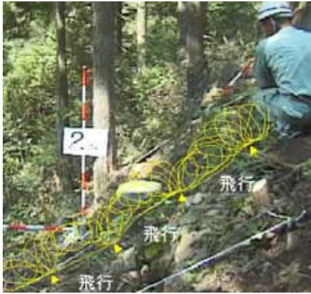
写真1 運動開始直後における砂岩塊(18kg)の挙動
