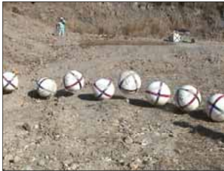
写真2 平坦地でのコンクリート球(直径54cm)の運動
