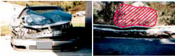
写真 7 被災した乗用車と落石が跳び越えたガードレール 6)
