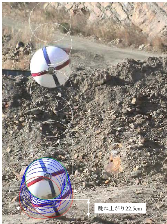
写真-4 衝突後のコンクリート球の跳ね上がり
