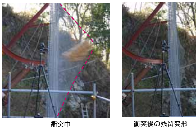
写真 1 重錘衝突時と衝突後の金網の変形
